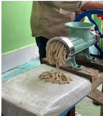
Gambar 3. Proses Pencetakan pakan
