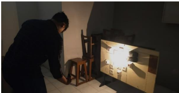
Gambar 3. Pengukuran intensitas (lux) pencahayaan berbagai jenis lampu
