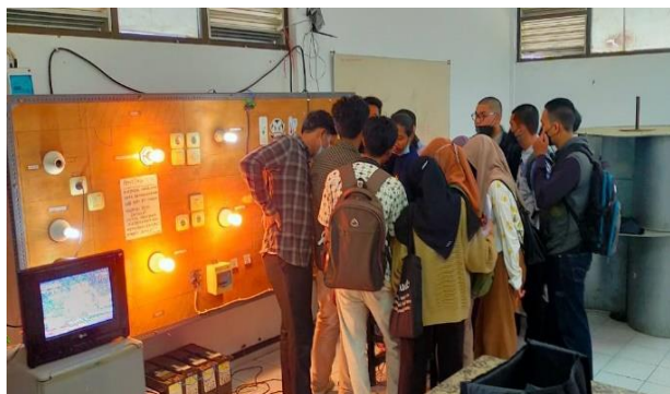
Gambar 7. Pengukuran konsumsi energi modul instalasi listrik yang standar dengan dua sumber PLN dan PLTS
