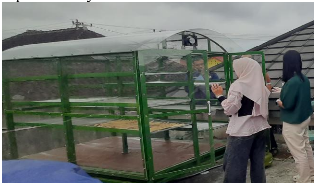
Gambar 3. Teknologi Pengeringan Sistem Hybrid Berbasis Energi Matahari
