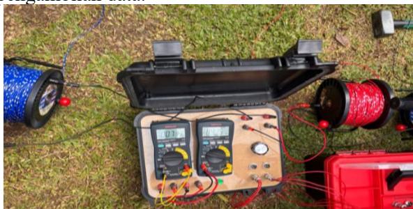
Gambar 4. Rangkaian konfigurasi alat geolistrik.
