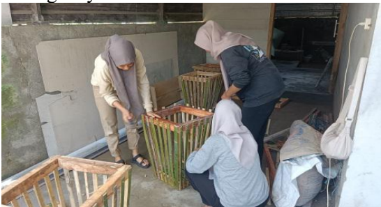
Gambar 4. Pemasangan Bambu Pada Kerangka
