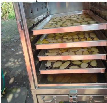
Gambar 5 Proses menyusun bahan buah di alat pengering tipe rak berbahan bakar gas
