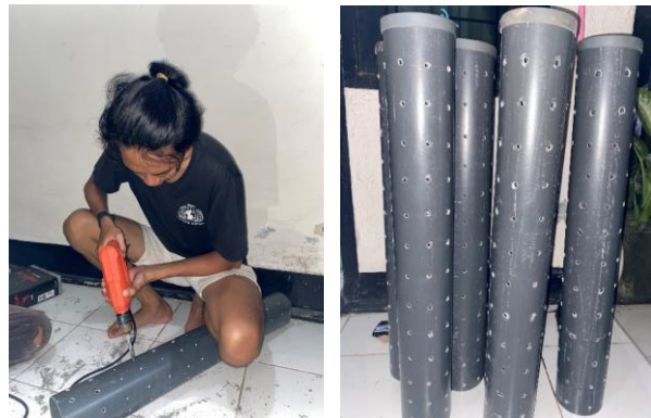
Gambar 1. Pembuatan Pipa LRB
