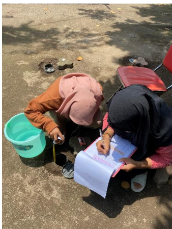
Gambar 4. Pengukuran penurunan muka air tanah dalam LRB
