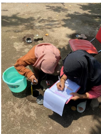
Gambar 4. Pengukuran penurunan muka air tanah dalam LRB
