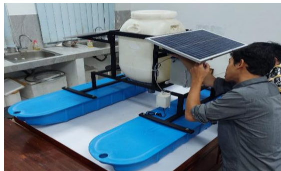
Gambar 6. Perakitan auto feeder menggunakan adruino system
