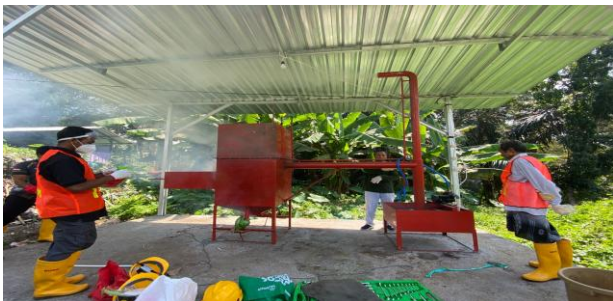
Gambar 4. Proses pembakaran sampah dengan alat insinerator sampah
