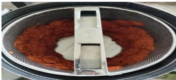
Gambar 3. Proses penirisan minyak dengan mesin spinner
