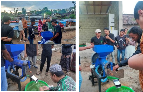
Gambar 5. Praktek Mesin Huller pada kopi Arabika proses Natural
