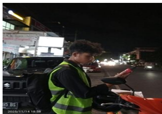
Gambar 5. Pengukuran intensitas penerangan PJU di Jalan Catur Warga
