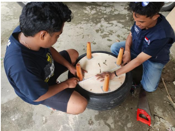
Gambar 1. Mengukur diameter pada papan lingkaran di atas ban bekas untuk menentukan posisi kaki meja agar seimbang.
