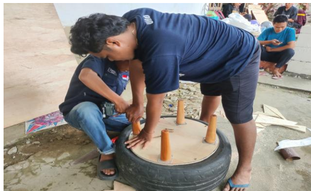
Gambar 3. Mengencangkan kaki kayu pada papan lingkaran di atas ban mobil bekas menggunakan alat bor/obeng listrik.
