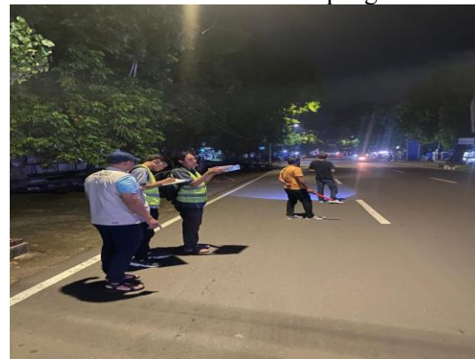
Gambar 2. Pengukuran intensitas pencahayaan PJU
