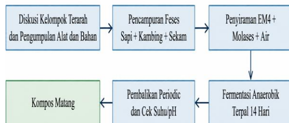
Gambar 2. Diagram Alur Proses Produksi Pupuk Kompos Bioaktivator Desa Sandubaya
