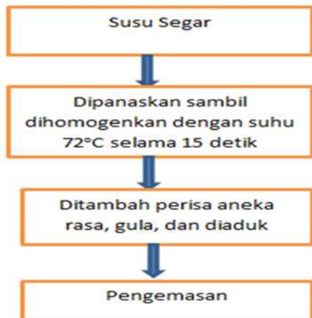
Gambar 3. Diagram Pembuatan Susu Pasteurisasi Aneka Rasa
