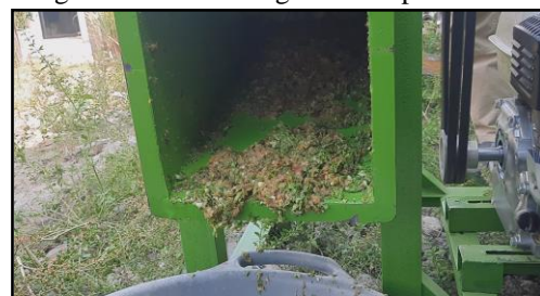
Gambar 10. Hasil pencacahan menggunakan mesin pencacah sampah organik
