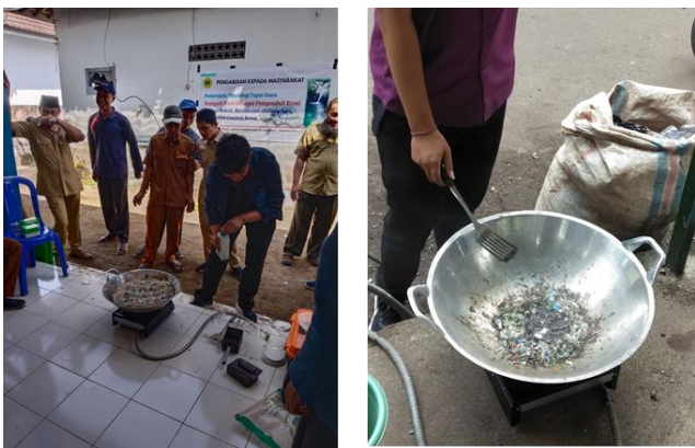
Gambar 2. Proses Pelelehan sampah plastik menjadi pasta
