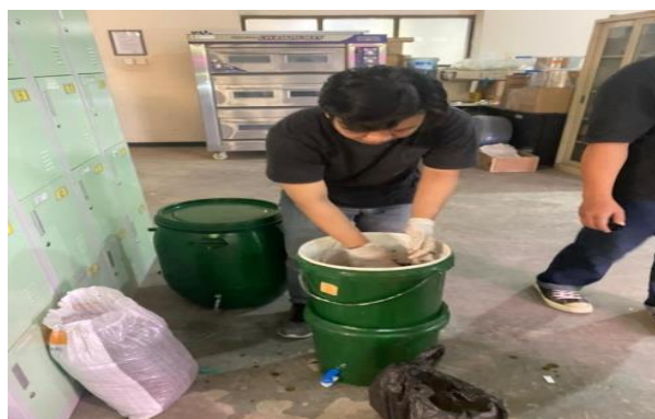
Gambar 3. Ujicoba pengolahan limbah kulit kopi, kakao dan pisang dengan komposter di Lab Teknik dan Konservasi Lingkungan Pertanian FATEPA Unram
