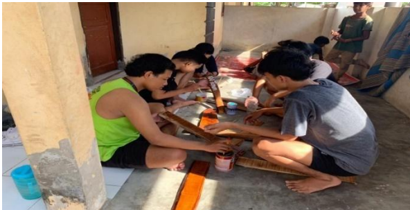
Gambar 9. Pengkilapan kayu dengan pernis untuk papan penanda jalan dan papan informasi
