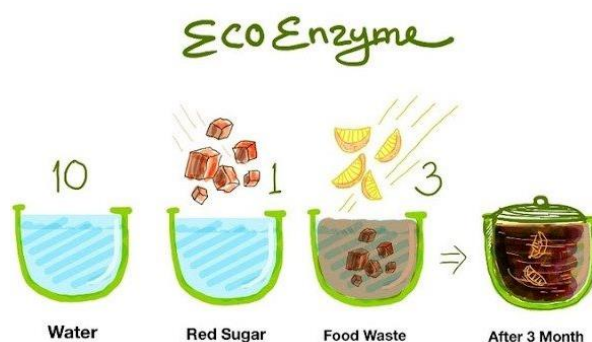
Gambar 4. Cara sederhana pembuatan eco-enzyme dari sampah organik dapur (Dimodifikasi dari Yusri & Zahra, 2023).
