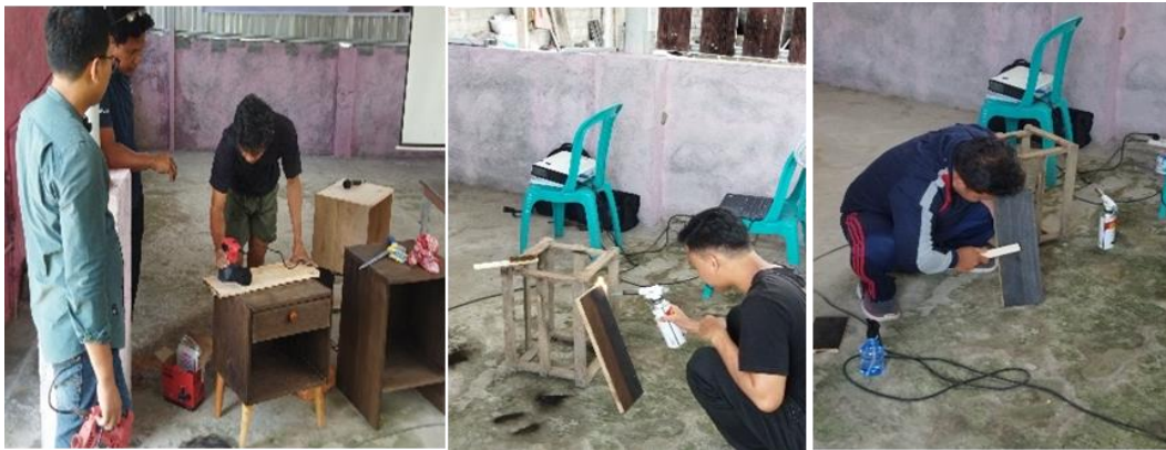
Gambar 2 Proses perataan permukaan kayu (kiri), proses pembakaran (Tengah) dan Proses pembersihan sisa pembakaran (kanan)
