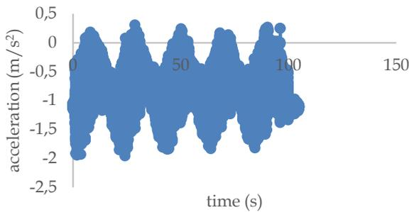
**Figure 12.** Smartphone sensor data on mini ferris wheels
